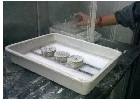
Water Sorptivity test, DI manual, SA
