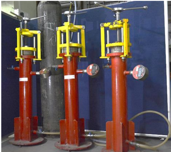
Oxygen permeability test, DI manual, SA
